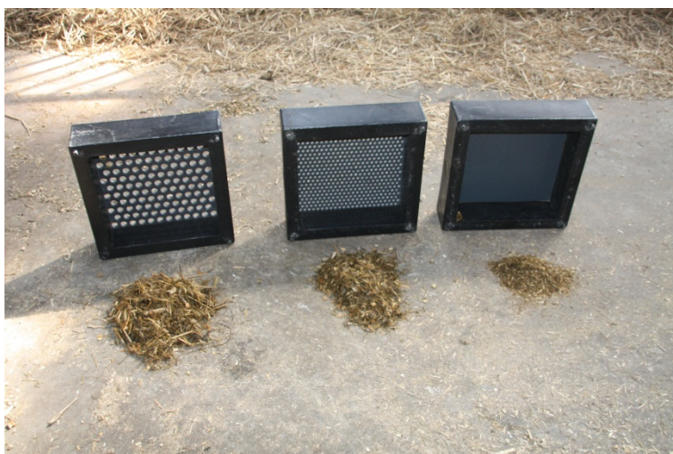
Tests med partikelseparator blev udført i pilotforsøget.
